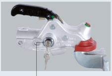
Option : antivol (position attelée et dételée) Introduire la clé dans le barillet et fermer
