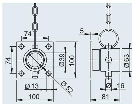
**Kit de fixation béquille Ø 70 basculable à 90°**
