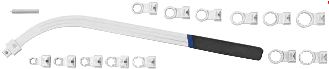
Art. nr 805015 Coffret clés polygonales coudées poulies de distribution et accessoires 15-pcs Tête interchangeable pour clé à poulie avec rallonge pour desserrer les boulons utilisés sur la distribution, le tendeur et la poulie auxiliaire.
