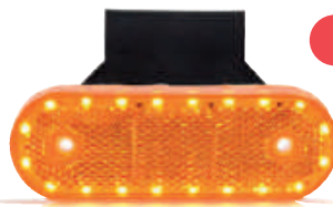
410264 Feu latéral + Clignotant avec catadioptré Sur patte équerre L 114 x l 40 x Ép 40 mm Câble 220 mm Possibilité d'ôter la patte équerre
