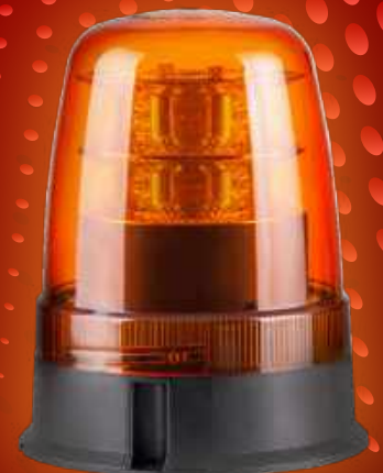
423308 H 173 x Ø 142 mm 250 mm de câble Cabochon polycarbonate Fixation : 3 trous Ø 6 mm sur 120° sur embase Ø 142 mm
